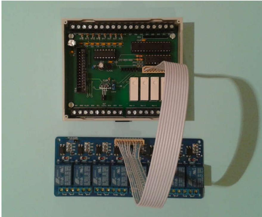
Bild 50: Hubo Hardware Rev. 1.00 mit externem Lastrelais (gilt für alle Hardware Rev.)
