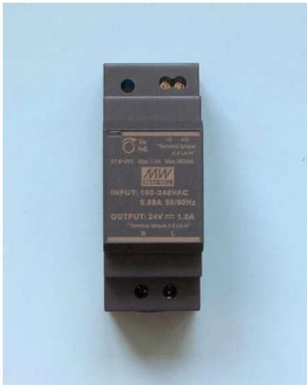
Bild 52: 24V Netzteil zur Speisung galvanisch getrennter Aktoren (z.B. Koppelrelais)
