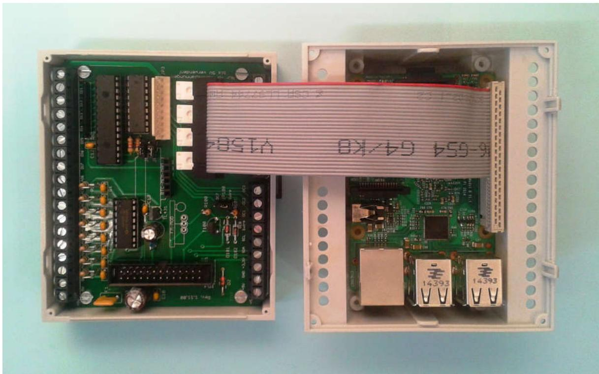
Bild 47: Hubo-Maxi Hardware Rev. 1.11 und Raspberry „Pi B+“ im Hutschienengehäuse
